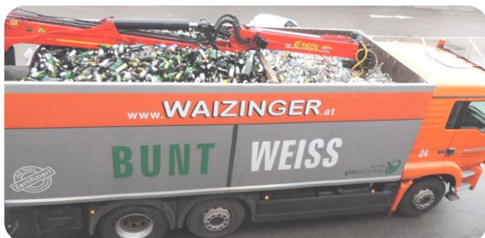
Foto: Von oben ist die Trennwand beim Sammel-LKW gut zu sehen.
